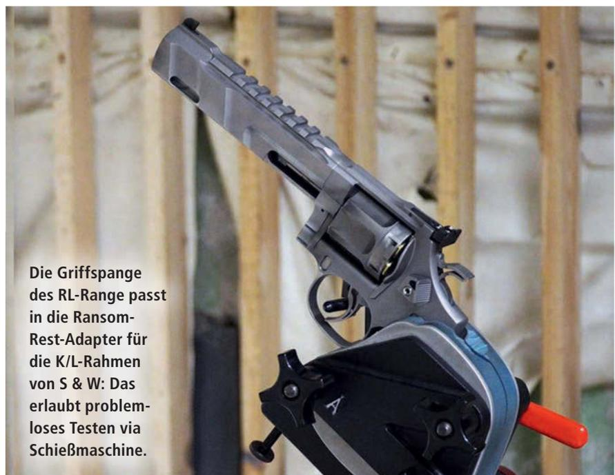
**Die Griffspanne des RL-Range passt in die Ransom-Rest-Adapter für die K/L-Rahmen von S & W: Das erlaubt problemloses Testen via Schießmaschine.**
