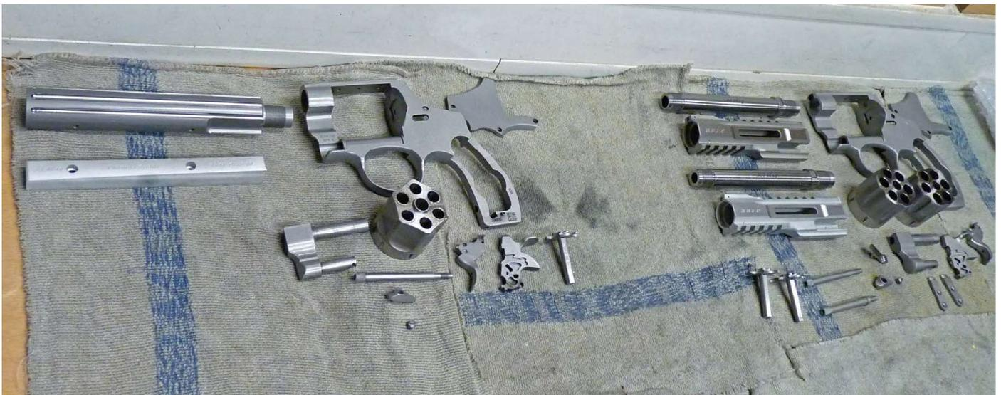
Vorbereitet für die Hartstoffbeschichtung: Zwei in ihre Bestandteile zerlegte Matchrevolver auf S&W-Basis.
